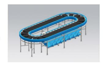
落盘分拣机一般采用椭圆形水平环状布局、单排或双排托盘的布置。被分拣的物品放置在托盘内沿着轨道在环线上 行走,到达指定位置后,托盘的两半就会像活动门板一样打开,产品随即垂直落入下方的滑槽上或物料箱内,实现 分拣动作。
