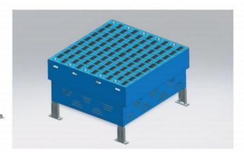
摆轮分拣机由电动滚筒(轮子)、转向装置、控制系统以及机架等组成,通过电动滚筒的旋转实现物品的传输,通过 伺服电机及转向模块改变电动滚筒的左右方向和角度来实现物品的分流。
