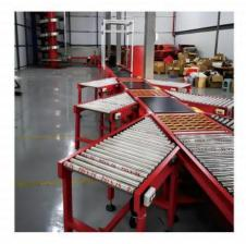
在制造业生产线上,摆轮分拣机可以帮助企业高效地处理原材料、零部件等物料,并将其分类存储。摆轮分拣机已在医疗、食品,新能源等领域得到广泛应用。
