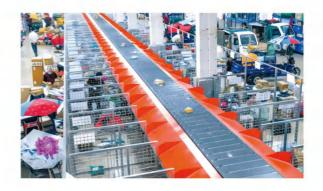
全球电子商务的蓬勃发展,物流效率已经成为电商商家的核心竞争力之一。面对不同包装、不同尺寸规格的商品,窄带分拣机均可帮助商家快速拣选到位,提高物流效率,缩短配送时间,减少人力成本。
