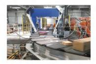
锐尔凯交叉带分拣机可根据用户需要配置智能视觉巡检功能,对所有在工作中的小车进行实时跟踪故障巡检,对有问题的小车系统会主动隔离不再循环上包,并进行及时封锁和告知用户,以免造成上包冲突或再次下包失败(该功能须配置自动供包台)。
