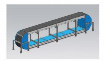
工作时,被分拣物品可用人工或自动上包的方式置于小车皮带上,当小车行进到目的地分拣位置时,控制系统发出信号并驱动皮带,完成物品分拣送出的任务。
